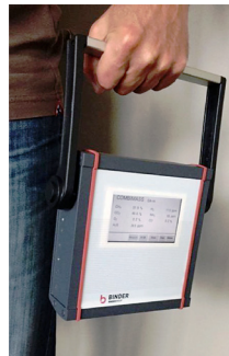
Kompletní sestava analyzátoru COMBIMASS GA-m a namontovaná sklopná rukojeť, kterou lze pořídit jako volitelné příslušenství
